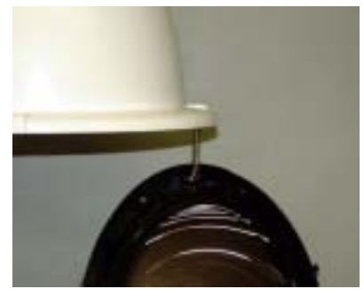
落下防止用のスプリングは必ず取付けてください
